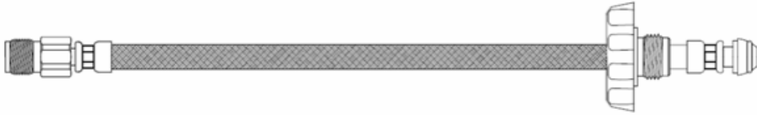
Figura 2. Conexión integral flexible Tipo 2 (ilustrativa, no limitativa)
