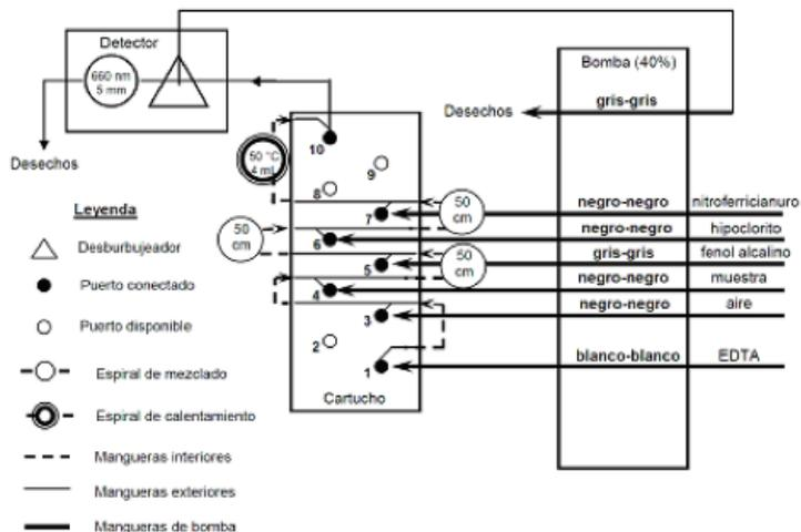
Fig. B.7.4-2. Configuración del cartucho para el análisis de N-NH<sub>3</sub>
