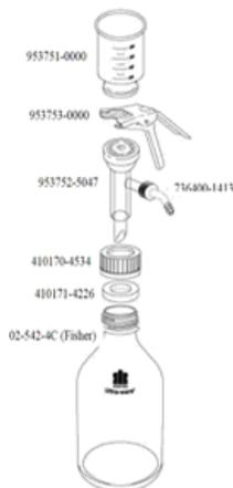
Fig. B.1.2-1 Partes del dispositivo de filtración
